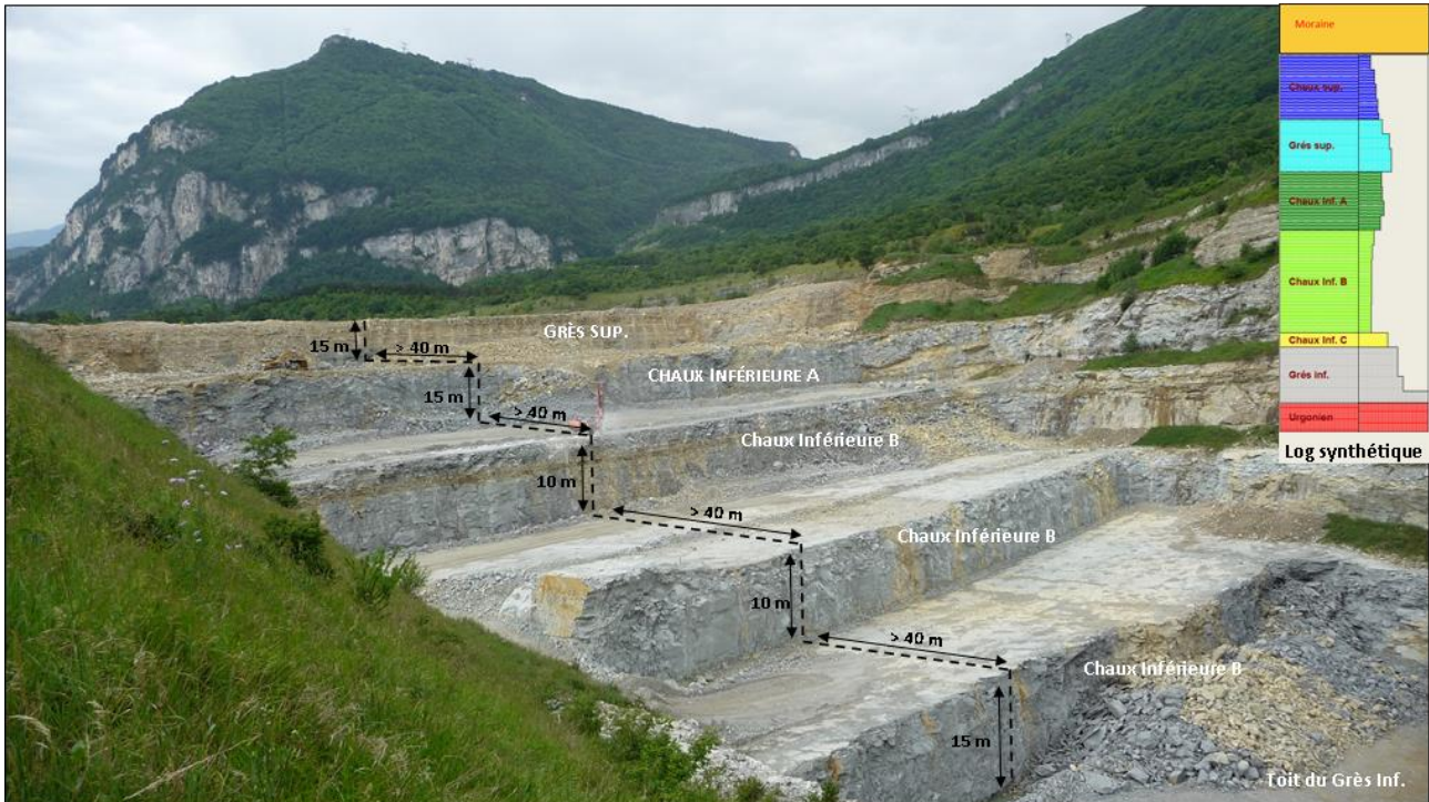
Photo 5 : Principe d'exploitation de la carrière selon la géologie.
