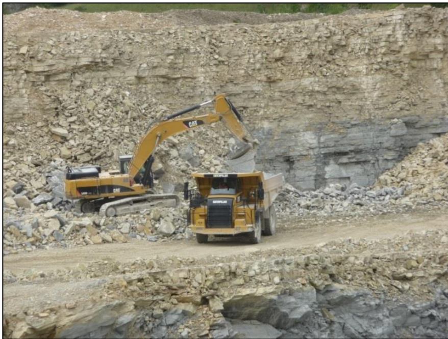
Photo 4 : Reprise des matériaux en pied de front – carrière des Côtes (2018).
